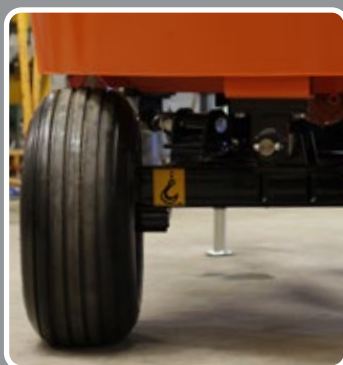
Chassi independente: Todo esforço do conjunto de mistura não é absorvido pelo chassi.
