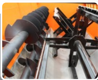
Rotor superdimensionado segmentado e raspadores intercambiáveis e substituíveis
