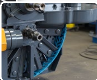
Máquina com peneira quebra grão removível
