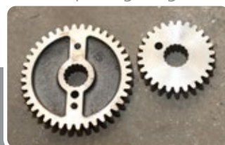
Sistema de troca de corte por engrenagens
