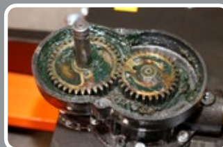
Engrenagens e eixos entalhados
