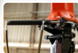
Giro da bica hidráulico
